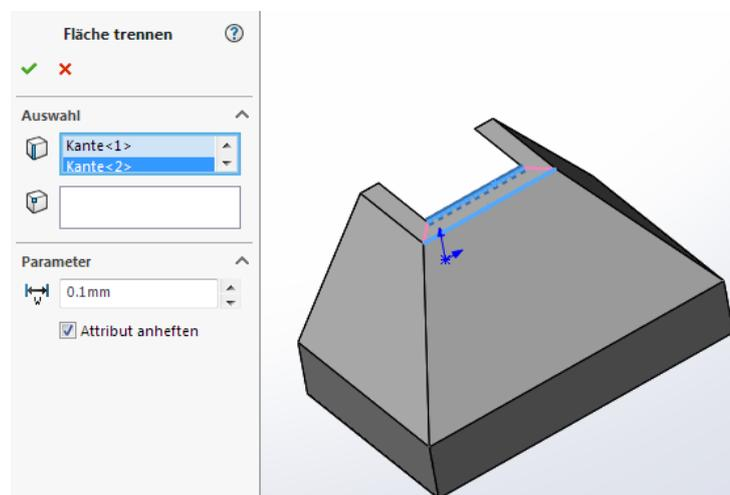
Die Vorschau zeigt die spätere Auftrennung der Kragenfläche. Wenn Sie das Kommando bestätigen, fügt **SPI SheetMetalWorks** hier eine Skizze ein, die als Trennlinie mit daran angehefteten Eckschlitzattributen genutzt wird.
