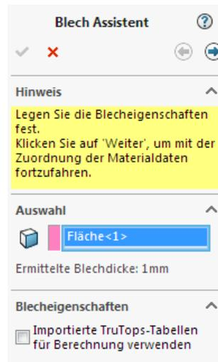
Wählen Sie im ersten Schritt eine Fläche des Blechteils und wechseln Sie anschließend auf den zweiten Teil des Assistenten (Pfeil nach rechts).
