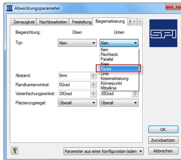
Bei Auswahl der Biegemarkierungstypen *Linie* oder *Kreismarkierung* werden die Biegemarkierungen lediglich als Kennzeichnung eingezeichnet. Mit dem hier gewählten Typ der *Raute* erhalten Sie Kerben an den Enden der Biegelinien:
