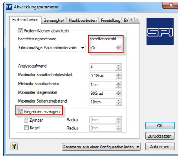
Die **Facettenanzahl** ist gleichbedeutend mit der Anzahl an Biegungen, in die eine gekrümmte Fläche aufgeteilt wird.
