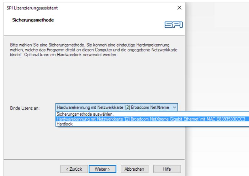
Neben der eindeutigen Hardwarekennung des Computers, welche die Lizenz an den jeweiligen Rechner bindet, können Sie mit der Option *Hardwarelock* eine Lizenzierung über einen Kopierschutzstecker, auch Dongle genannt, vornehmen. Der entsprechende USB-Dongle kann kostenpflichtig bei SPI bestellt werden. Der Betrieb eines Dongles bietet sich dann an, wenn Sie eine Lizenz auf verschiedenen Rechnern (z. B. im Büro und zu Hause) nutzen möchten.
