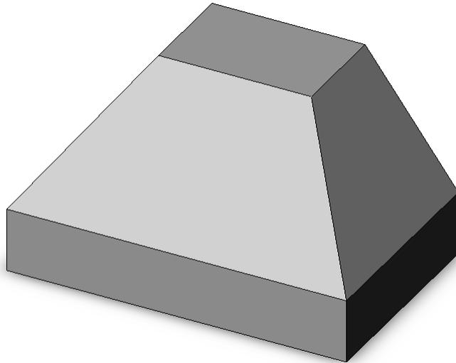
Bitte öffnen Sie die Datei **Haube-Grundkörper.sldprt**. Aus diesem Grundkörper wird durch zweimaliges Anwenden des Kommandos *Wandung* ein scharfkantiges Blechteil:
