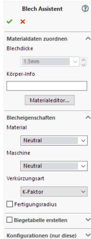
Wenn es sich – wie in diesem Beispiel – um ein SOLIDWORKS Blechteil handelt, wird die bereits modellierte **Blechdicke** im Dialog ausgewiesen und kann nicht geändert werden. Eine Änderung ist nur direkt über das SOLIDWORKS Blech-Feature möglich.
