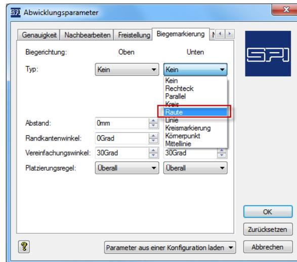
Bei Auswahl der Biegemarkierungstypen *Linie* oder *Kreismarkierung* werden die Biegemarkierungen lediglich als Kennzeichnung eingezeichnet. Mit dem hier gewählten Typ der *Raute* erhalten Sie Kerben an den Enden der Biegelinien:
