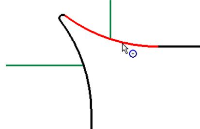
Die Ecke besteht aus Kreisbögen, die tangential in Linien übergehen - perfekt für die NC-Programmierung.
