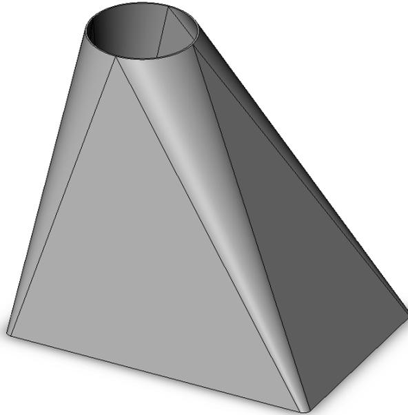
Unter Umständen müssen Sie in den **Abwicklungsparametern** auf der Registerkarte **Freiformflächen** die Genauigkeitseinstellungen auf gröbere Werte einstellen, bevor Sie das SPI-Kommando **Abwicklung erzeugen** aufrufen. Nähere Informationen dazu finden Sie in der Online-Hilfe zu **SPI SheetMetalWorks**.
