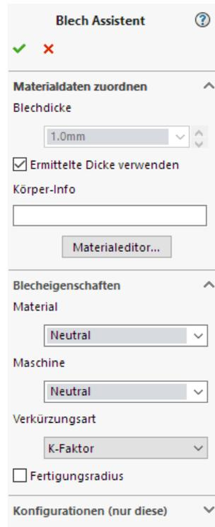
Die Blechdicke wird automatisch aus der Geometrie ermittelt. Falls die ermittelte Dicke nicht stimmt, können Sie die korrekte Blechdicke eingeben oder über die Auswahl einer Fläche ermitteln lassen. Deaktivieren Sie dazu die Option *Ermittelte Dicke verwenden*.
