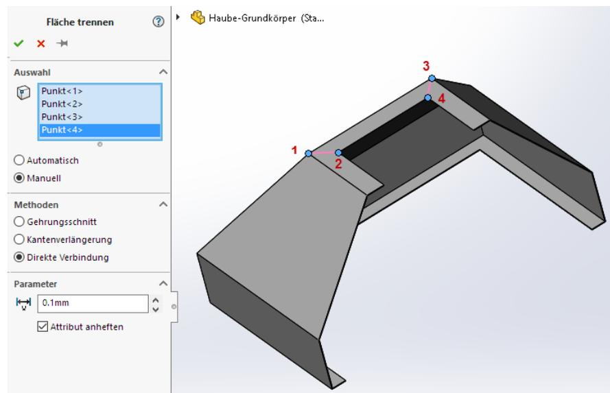
Die Vorschau zeigt die spätere Auftrennung der Kragenfläche. Wenn Sie das Kommando bestätigen, fügt **SPI SheetMetalWorks** hier eine Skizze ein, die als Trennlinie mit daran angehefteten Eckschlitzattributen genutzt wird.
